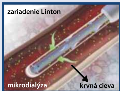
Obr. 5 | Schematická ilustrácia mikrodialyzačného katétra pre monitorovanie glykémie [12]
